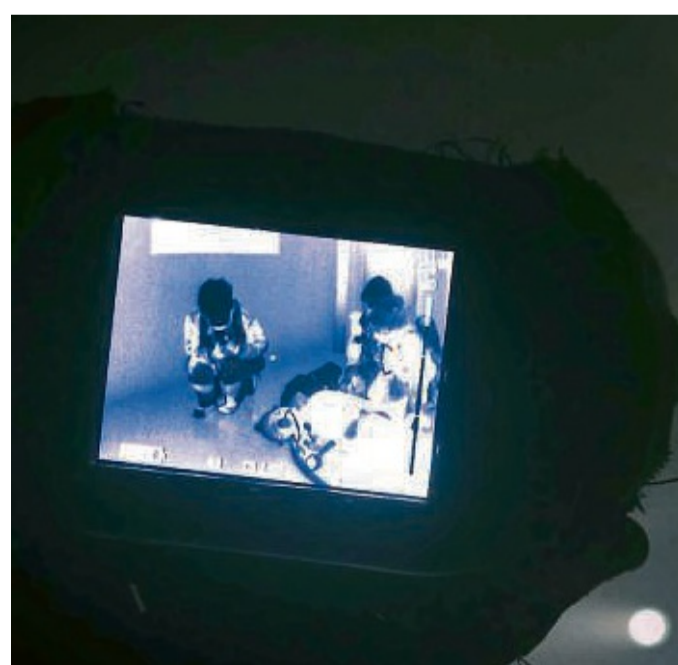
Der Blick durch die Wärmebildkamera: Warme Objekte senden Infrarotstrahlung aus. Diese Kamera macht sie sichtbar. Unser Foto zeigt drei Atemschutzgeräteträger kniend vor einem „verunglückten“ Feuerwehrmann (unten rechts).
